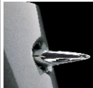
ВЧ-головка полностью изолирована от корпуса; обратные волны выходят через специальные отверстия на острие
