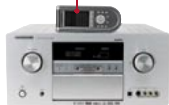
AV-РЕСИВЕР Сердцем комплекта является Marantz SR-9600, обеспечивающий 140 Вт на каждый из семи каналов, что позволяет озвучить достаточно большое помещение
